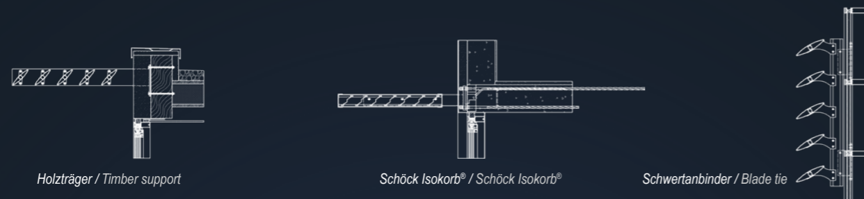
Befestigungsbeispiele an bauseitiger Unterkonstruktion mit MLL-Sonnenschutzsystemen. / Mounting examples on on-site substructure with MLL sun protection systems.
